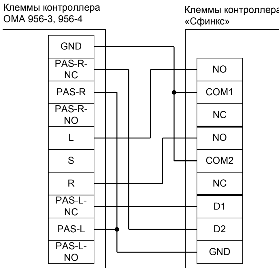
Рисунок 65. Подключение турникета ОМА с контроллером ОМА 956-3, 956-4.
