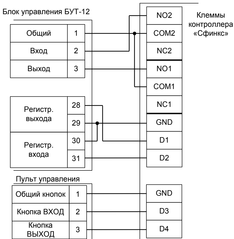
Рисунок 86. Подключение турникетов «Форма».
