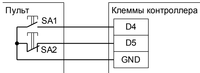
Рисунок 112. Подключение пульта ручного управления воротами, вариант №2.
