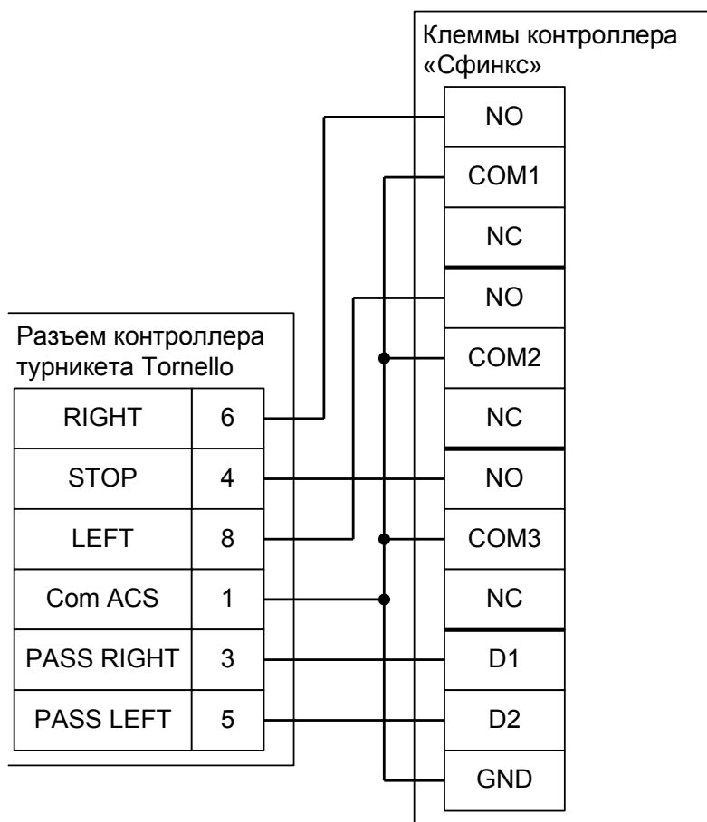
Рисунок 97. Подключение турникетов Tornello.
