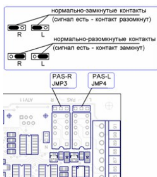
Рисунок 68. Перемычки JMP3 и JMP4 контроллера ОМА 264MC1.
