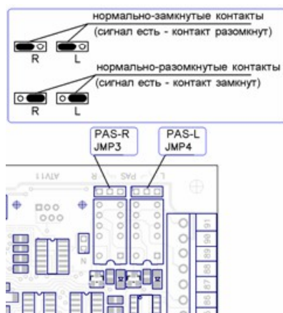
Рисунок 63. Перемычки JMP3 и JMP4 контроллера ОМА-DD.958, ОМА 264МС1.
