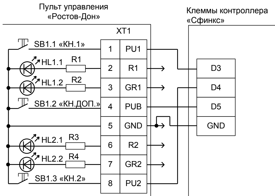
Рисунок 80. Подключение пульта управления Ростов–Дон, старая электроника.
