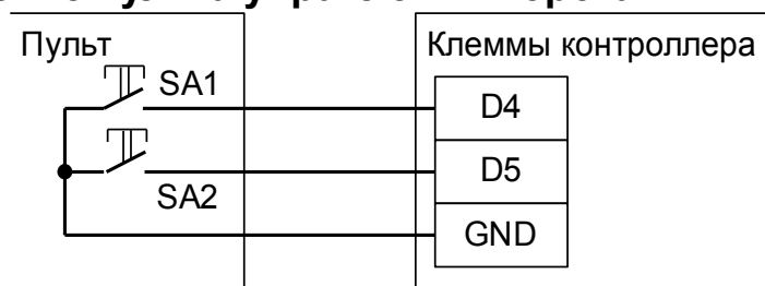
Рисунок 111. Подключение пульта ручного управления воротами, вариант №1.
