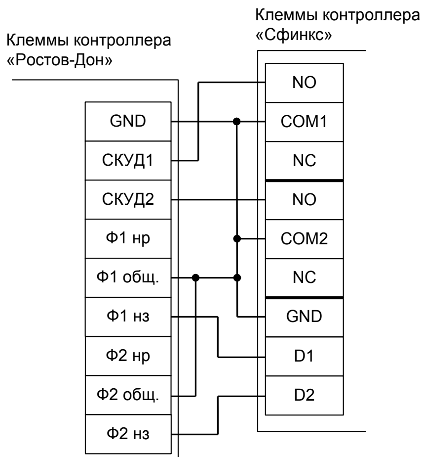
Рисунок 75. Подключение турникетов и калиток «Ростов–Дон», новая электроника, вариант №2.
