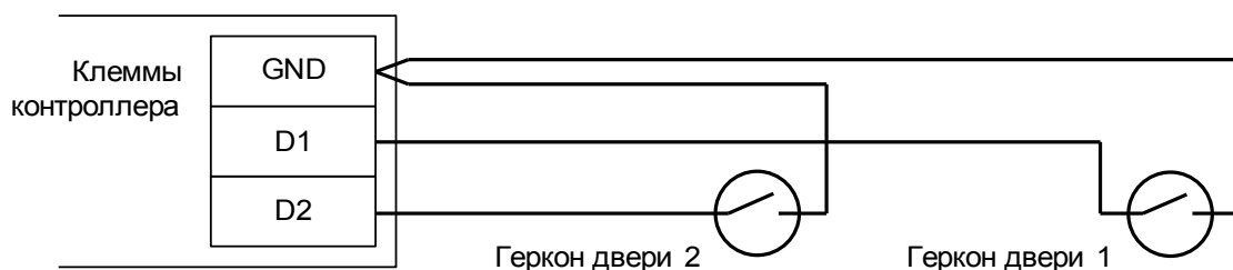
Рисунок 25. Подключение датчиков открытия дверей.
