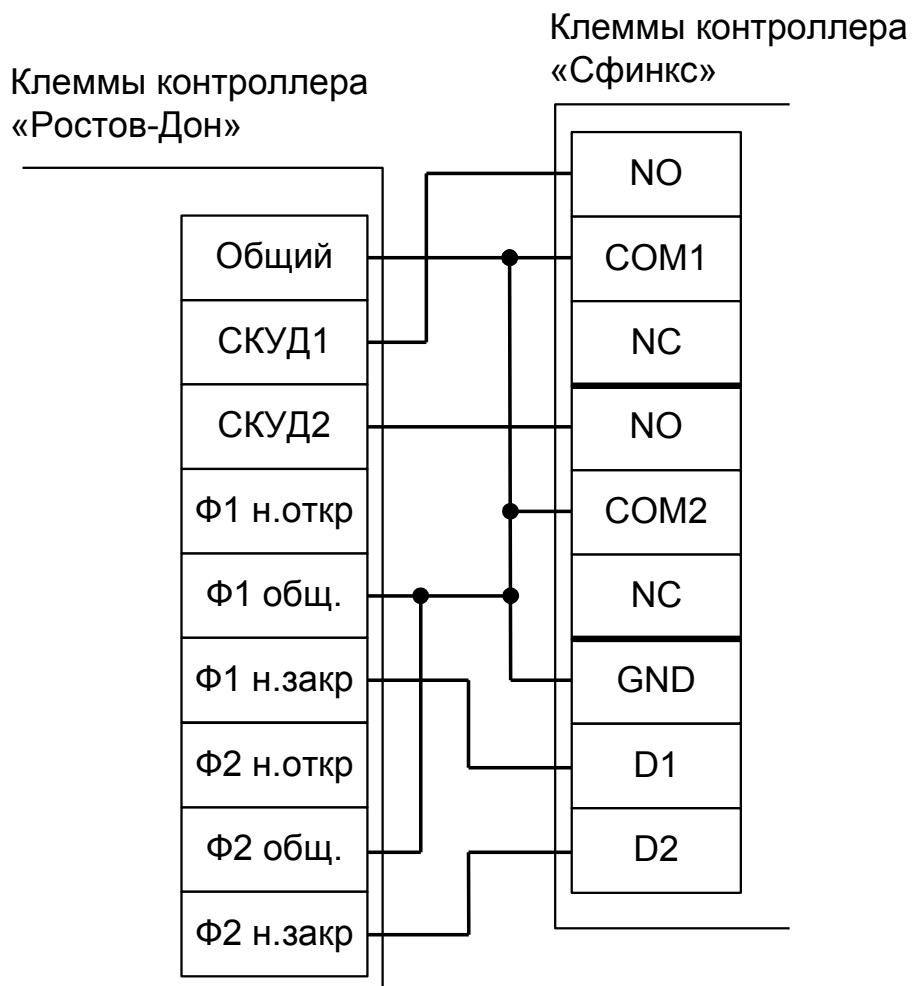
Рисунок 74. Подключение турникетов и калиток «Ростов–Дон», новая электроника, вариант №1.
